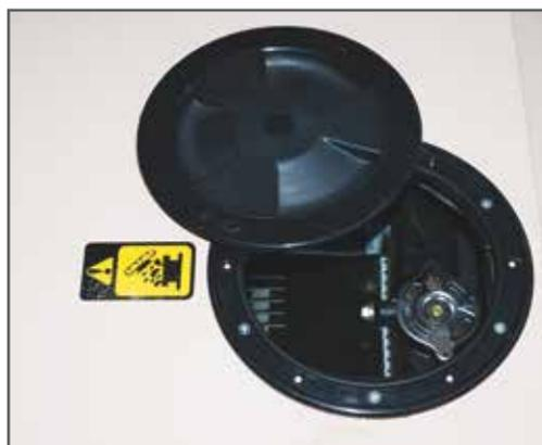
▲ Wasserdichter Nautik-Verschluss für den Zugang zum Kühler
