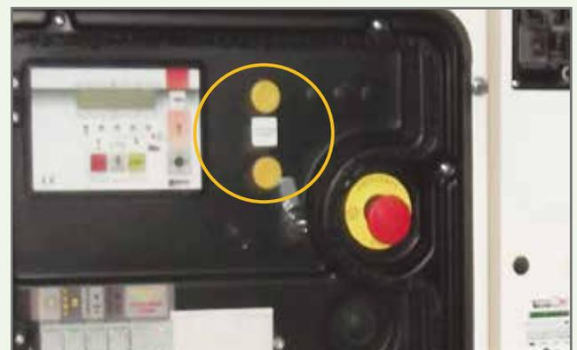
▲ Auf- und Ab-Taster um den hydraulischen Lichtmast aus- und einzufahren
