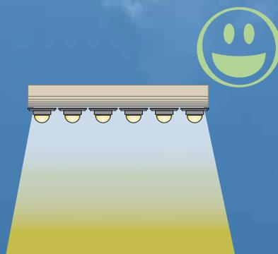
Im Vergleich zu Metall-Halogen Lichtquellen, streut das **LED** Licht einzig in Richtung des ausgeleuchteten Punktes und ist somit viel effizienter.
