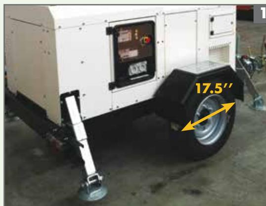
Dieses Lichtmastaggregat ist mit 4 HYDRAULISCHEN STÜTZEN ausgestattet [1, 2], die Ausrichtung erfolgt über die Hydraulik-Steuerung [3] und die 17,5" RÄDER.
