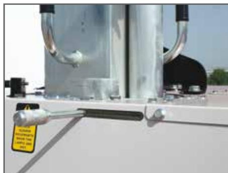
▲ Windbremse Lichtmast
