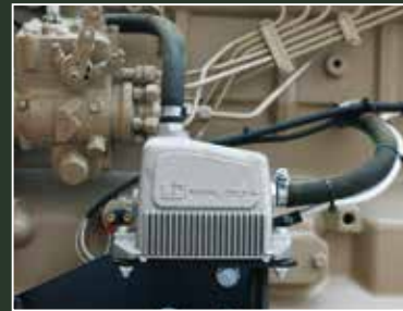
▲ Elektrische Standheizung (fremdversorgt)
