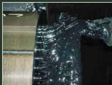
▲ Generator mit Tropenisolation
