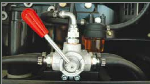
▲ Umschaltarmatur für externen Tank
