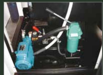
▲ Automatische Kraftstoff-Nachförderung (Details auf Seite 7)
