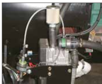
▲ Diesel-powered coolant pre-heater Préchauffage eau alimenté par diesel
