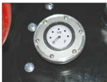
▲ Mechanical fuel level reading placed next to the filling point Lecture mécanique niveau carburant placé à côté du point de remplissage
