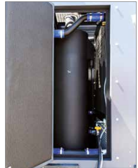
▲ Silencer in compartment completely insulated, with spark arrester. Silencieux dans le compartiment entièrement isolé, avec pare-étincelles
