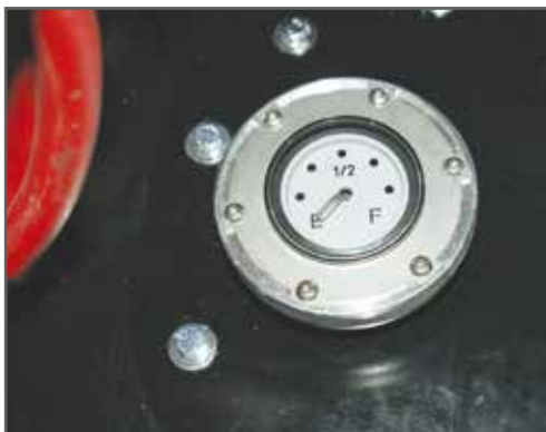
▲ Mechanische Füllstandanzeige neben dem Einfüllstutzen
