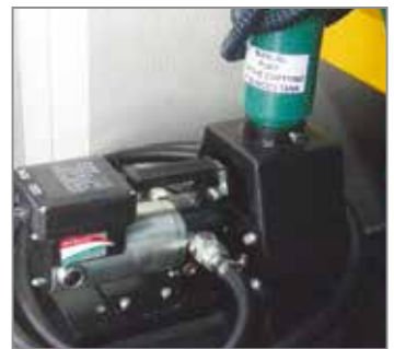
▲ Elektrische Pumpe zur Befüllung und Entleerung des Motorenöls Electric oil refilling/emptying pump
