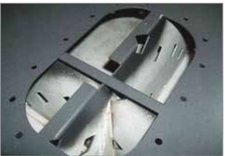
▲ Schwallbleche Kraftstofftank Internal baffles for fuel sloshing control
