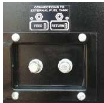
▲ Umschaltung Einachs-Straßenanhänger Kraftstoffversorgung
