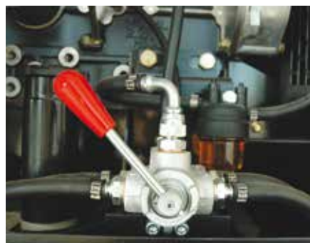
▲ Umschaltung Einachs-Straßenanhänger Kraftstoffversorgung
