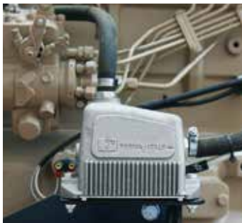
▲ Elektrisch betriebene Kühlmittelvorwärmung
